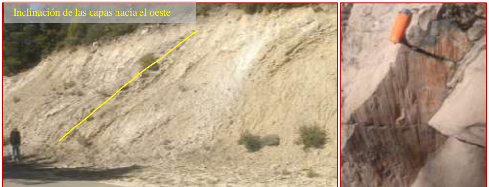
Figura 4. A la izquierda capas areniscosas y margosas inclinadas. A la derecha, estrías en calizas.
