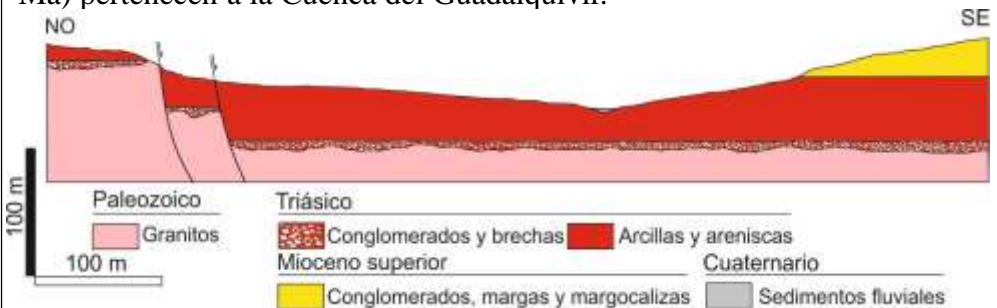
Figura 10. Corte geológico transversal a la carretera Linares-Arquillos. (Simplificado del elaborado por R. Aguado y J. Rey)
