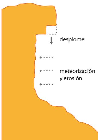
**Desplome.** Desprendimiento de un bloque de roca de trayectoria totalmente vertical.
