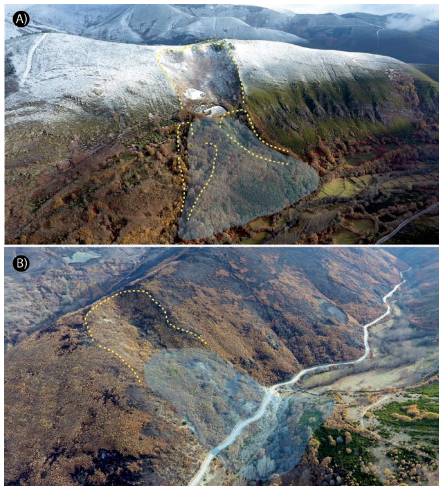
Fig. 2.- Imágenes aéreas oblicuas de los movimientos en masa de: A) Tejedo de Ancares y B) Silván (La Cabrera). Las líneas discontinuas marcan la posición del escarpe de rotura. En transparencia la masa desplazada. Ver figura en color en la web.
