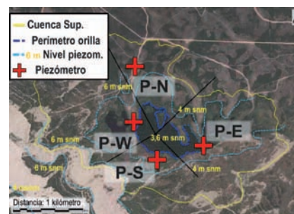
Fig. 2.- Perímetro de la laguna de Santa Olalla, cuenca hidrológica superficial y piezómetros empleados en el estudio. Se señala la división por segmentos de la laguna para la aplicación del método y el nivel piezométrico.
