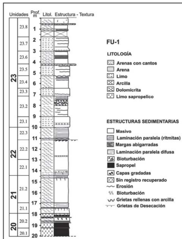
Fig. 2.- Columna estratigráfica de los primeros 20 m del sondeo FU-1.
