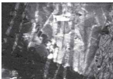
Fig. 4 Imagen en CL-MEB de bandas de fuerte emisión en un cristal de cuarzo y que se asemejan a las maclas de una plagioclasa. Muestra PG-6.
