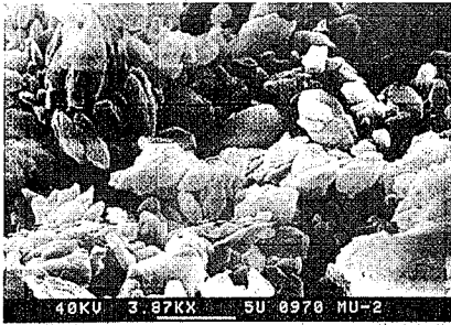
Fig. 3.- Cristales de yeso de una subfloreescencia salina desarrollada bajo las placas de piedra que se desprenden en los sillares.
