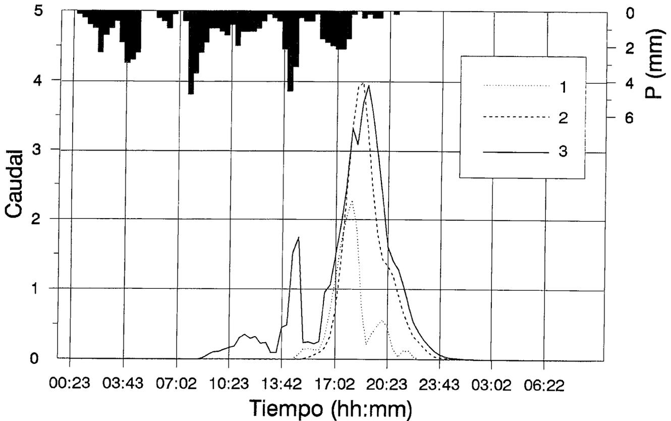
Fig. 3.- Hietograma e Hidrograma de crecida para la tormenta del 16 de Febrero de 1994 (caudal en m<sup>3</sup>/s); 1: hidrograma generado en la cuenca superior; 2: hidrograma en la cuenca media y 3, hidrograma global de la cuenca.
