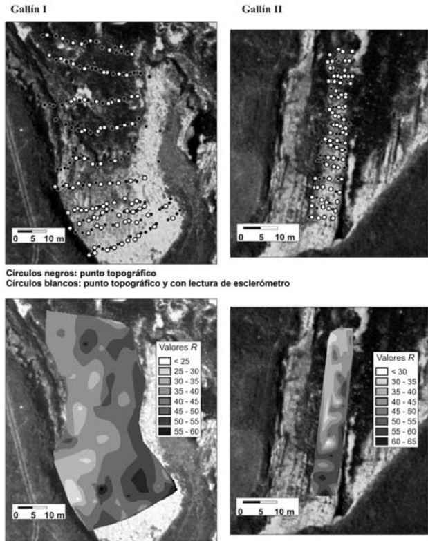
Figura 6.- Arriba, distribución de los puntos topográficos y puntos de aplicación del esclerómetro en Gallín-I y Gallín-II. Abajo, modelo digital interpolado de los valores R en Gallín-I y Gallín-II.
