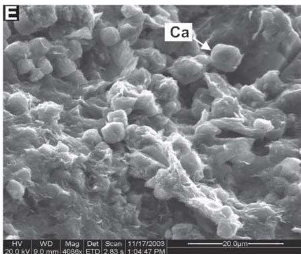
Figura 6.- Imágenes de SEM de muestras pertenecientes a la brecha fangosa de la zona TASYO. Volcán de fango Almazán (A-D) y Faro (E-F). Se observa la matriz arcillosa formada por láminas de filossilicatos, calcita (Ca), cristales euhédricos de dolomita y piritita en forma framboidal y acumulaciones de cristales aislados. Además otros minerales detríticos como el apatito (Ap), albita (Alb) y cuarzo (Cu). Ye: yeso.
