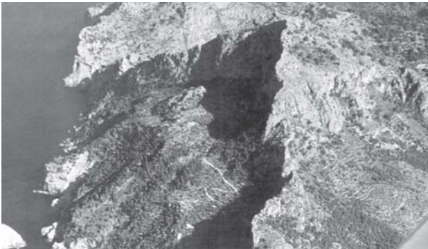
Figura 6.- Vista oblicua y ortofoto del deslizamiento en cuña de Bálitx, en la costa de Sóller, donde se observa con claridad los dos planos de rotura.
