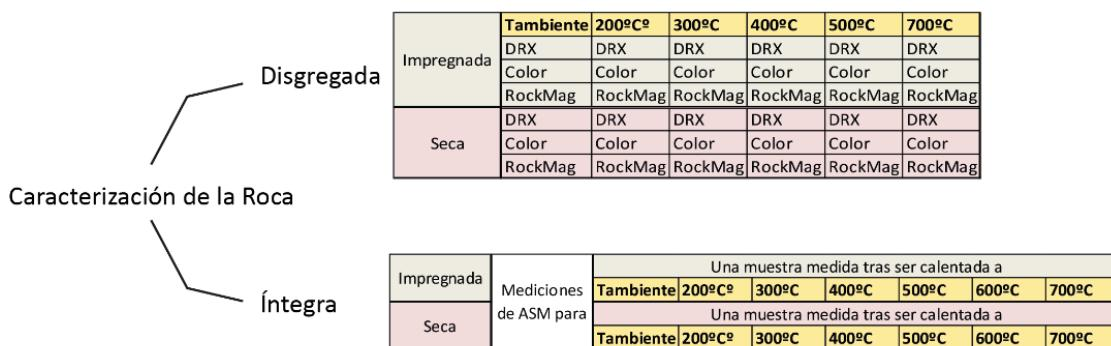
Figura 2.- Técnicas utilizadas para la caracterización de la roca.
