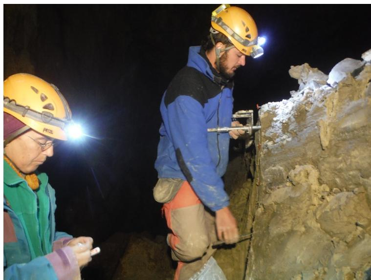
**Figura 1.** - Toma de medias de dirección en inclinación en las muestras discretas
