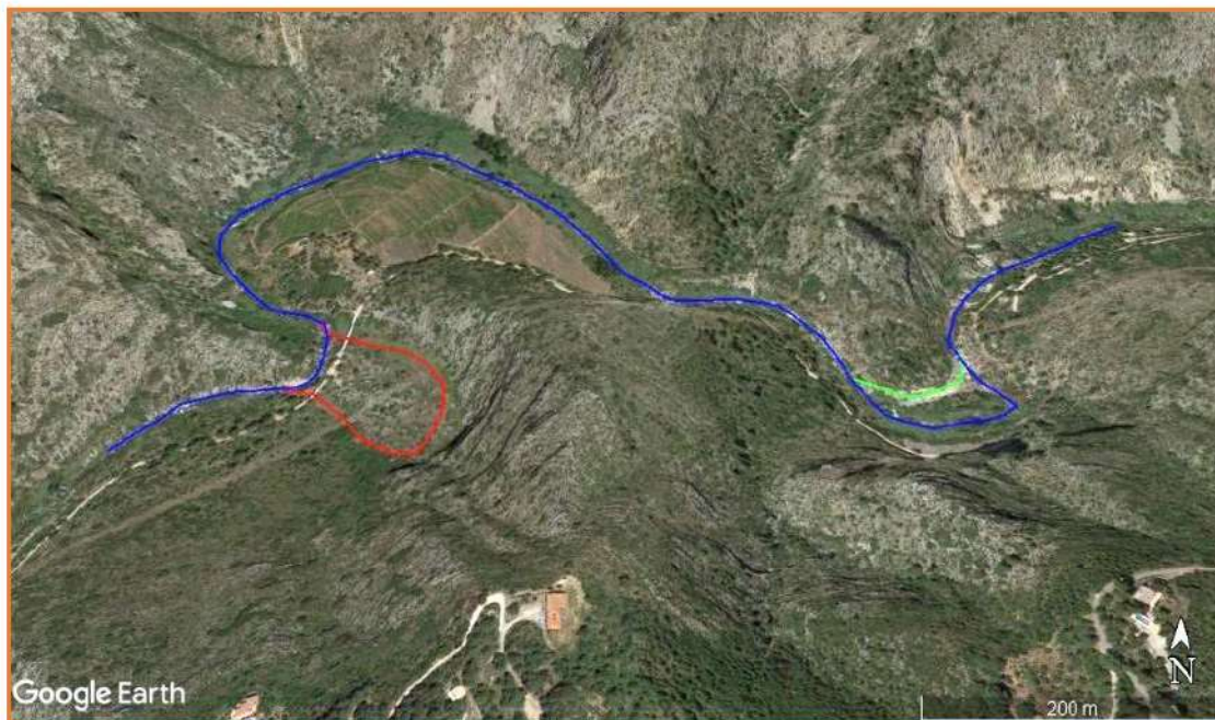
Fig. 18 Vista de los meandros en distintos estadios de abandono del Serpis (rojo: abandonado y verde: futuro cauce de estiaje) (2)
