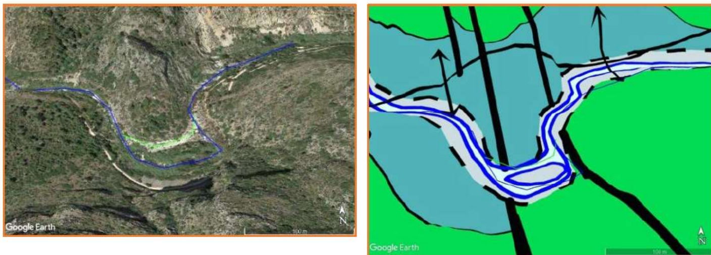
Fig. 12a. Trazas del cauce del Serpis en el meandro «semiabandonado»; canal de estiaje (azul) y canal de crecidas (verde). Derecha. Recorte de la geología correspondiente al meandro «semiabandonado» (imagen de la izda.) donde se observan fracturas (trazo negro grueso) condicionando el trazado del cauce del Serpis (2)
